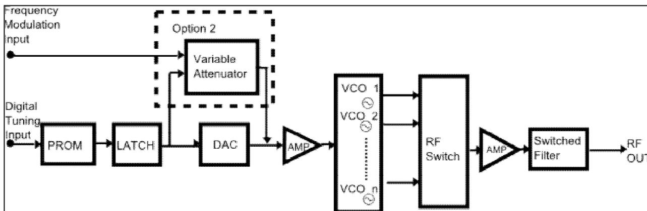
**Fig. 2.** Multi Band DTO Block Diagram
