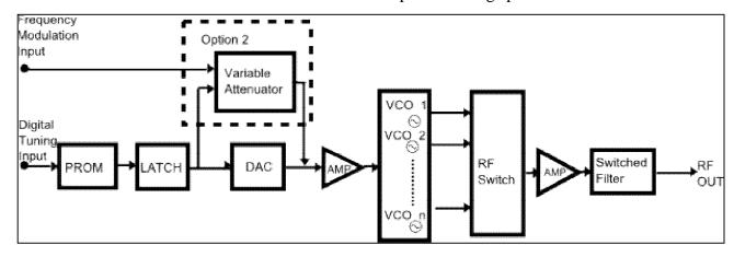
Fig: 2. Multi Band DTO Block Diagram
